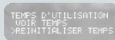
Vers l'option pour réinitialiser le temps, le remettre à zéro. Appuyer sur la flèche de droite pour entrer dans l'option.
