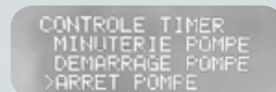
Fonctionnalité vers l'heure d'arrêt du minuteur qui permettra de choisir l'heure de la fin d'activation. Flèche de droite pour entrer dans l'option.
