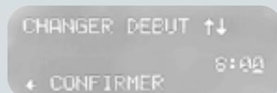
Confirmation de l'heure de démarrage. On utilise la flèche du haut et du bas pour sélectionner et on confirme avec la flèche de gauche.
