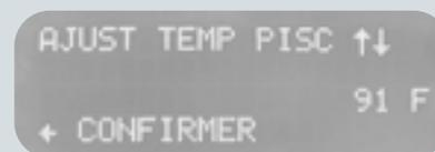
Ajustement de la température de la **piscine/spa**. Les flèches, haut et bas, servent à l'ajustement, celle de gauche confirme le choix.
