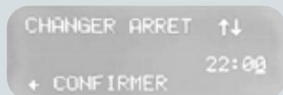
Confirmation de l'heure de fin. On utilise la flèche du haut et du bas pour sélectionner et on confirme avec la flèche de gauche.
