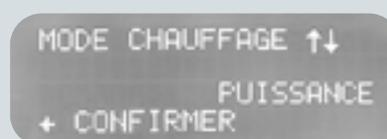
Activer le mode **puissance/performance** en confirmant avec la flèche de gauche. Le mode Performance, quant à lui, fournit 100 % de la capacité de chauffage de la thermopompe afin de maintenir l'eau à la température cible le plus rapidement possible. Le compresseur fonctionne à sa pleine capacité et la ventilation augmente pour capter le plus de chaleur possible dans l'air et la transmettre à la piscine.
