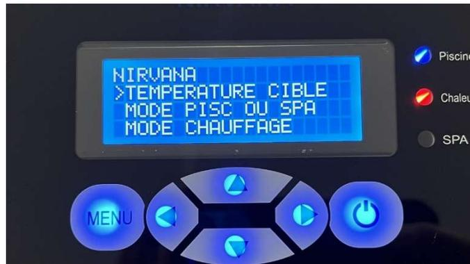
Température cible : Ajuster la température désirée avec les flèches haut et bas et confirmer votre choix avec la flèche de gauche.
