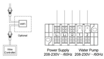
Remarque: Si la puissance de la pompe à eau est supérieure à 800W, ne le branchez pas à la plaque de raccordement à l'intérieur de la pompe à chaleur. Utilisez un contacteur externe, ainsi qu'un disjoncteur séparément.
