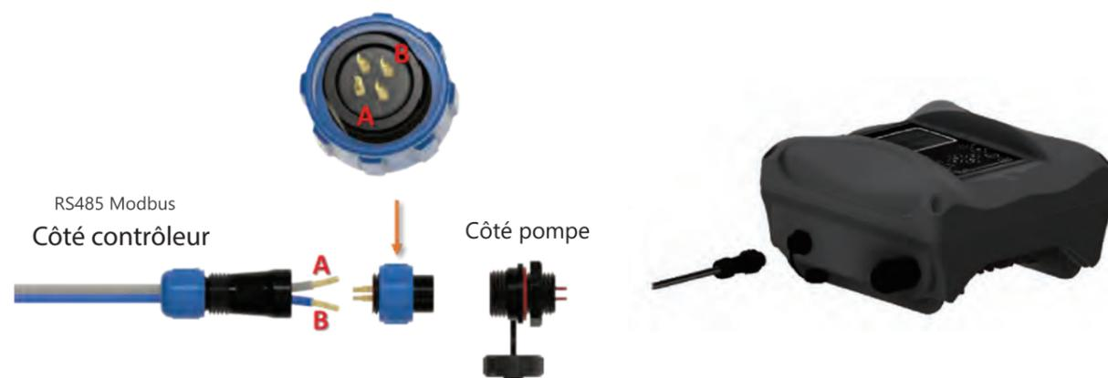
Pour le câblage longue distance, la broche 4 est nécessaire pour la programmation et une résistance terminale de 20 ohms sur la ligne signalétique A / B.
