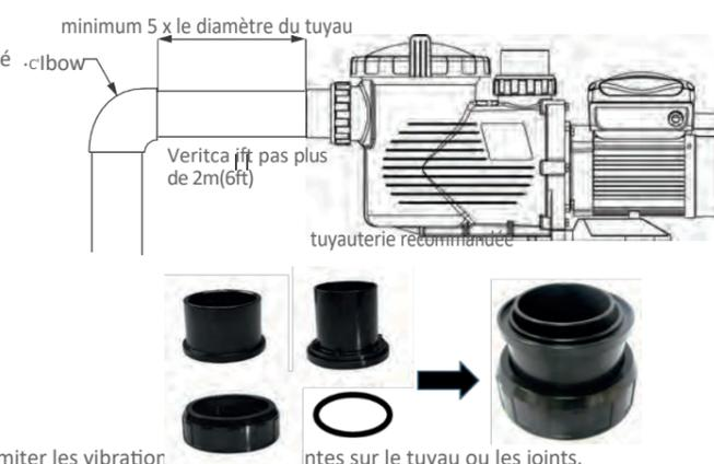
Remarque : Les raccords d'aspiration et de refoulement de la pompe présentent des butées de filetage, n'essayez PAS de visser le tuyau au-delà de ces butées.
